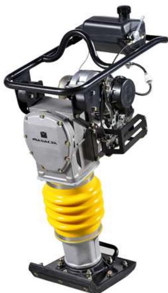
Вибротрамбовка MR72H оснащается бензиновым двигателем Honda GX120. Мощный двигатель обеспечивает ударную силу в 13.5кН, что идеально подходит для выполнения тяжелых уплотнительных работ. Эффективный карбюратор совместим с различными сортами топлива, и может обеспечить стабильную работу даже при тяжелых рабочих условиях.
