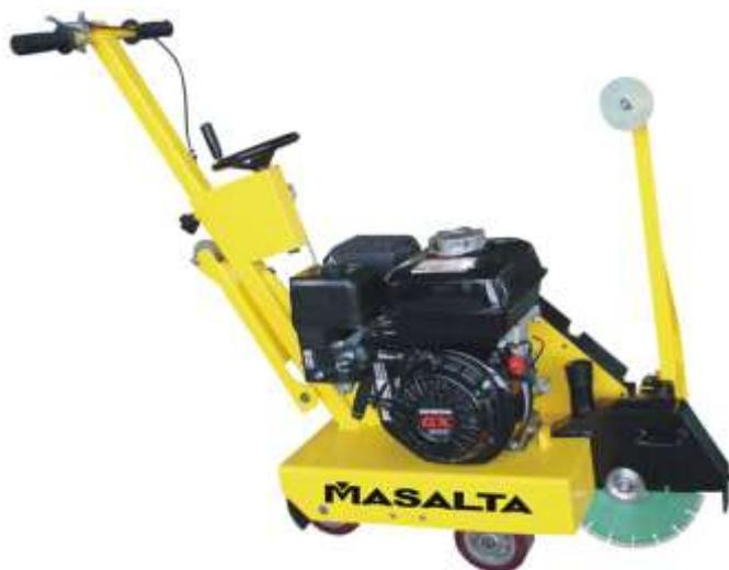
Резчик свежего бетона MFG10 – это компактное и легкое устройство. Универсальная пила используется для декоративной резки и разрушения небольших обломков. Устройство также способно разделять деформационные швы для свежего бетона. При работе со свежим бетоном, рекомендуется использовать сухой лазерный диск для предотвращения недорезов. Глубина резки может быть настроена с помощью легкодоступного рычага. Задний указатель выступает в качестве ориентира и способствует прямой резке.
