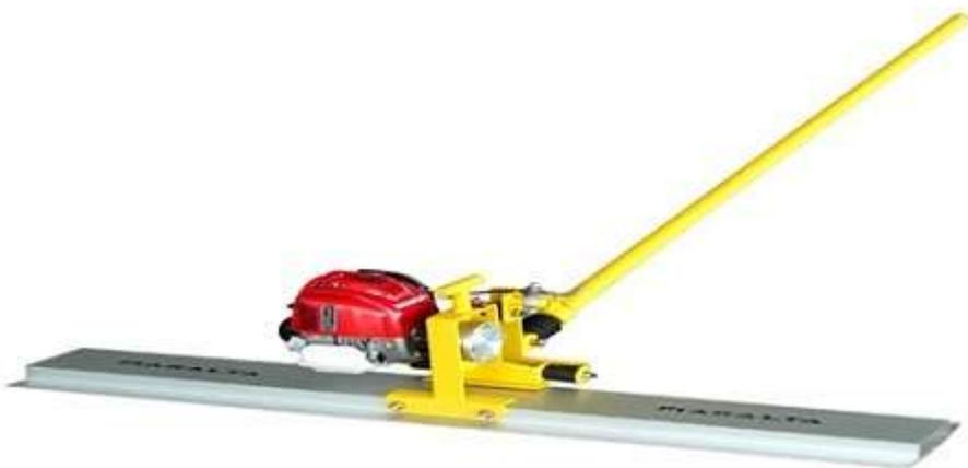
Вибрационная рейка с колебательным механизмом, позволяющим работать в обоих направлениях, обеспечивает точный уровень без использования направляющих. Она спроектирована для уменьшения времени выравнивания и экономии при отделке больших участков бетона. Вибрация лезвия улучшает уплотнение бетона и уменьшает время затирки свежеложенного бетона.
