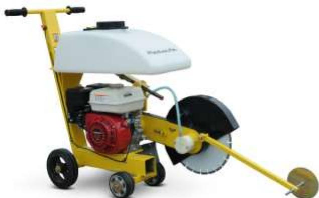
Шовнарезчики фирмы Masalta - это мощное, долговечное и надежное оборудование. Работают по бетону или асфальту, укрепленная стальная рама позволяет уменьшить вибрацию при нарезке швов. Минимизация вибрации увеличивает срок службы диска. Быстрая окупаемость - за 1 месяц!
