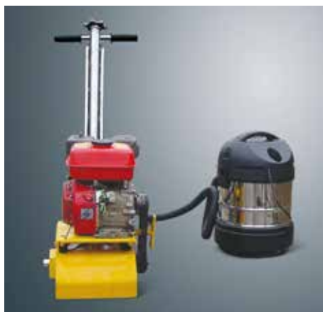
Система контроля пыли с универсальным пылесосом – поставляется как опция
