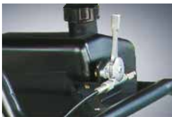
Оригинальный рычаг дроссельной заслонки для бесперебойной работы
