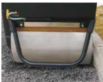
Узкий зазор для работы вблизи от стен и бордюров.
