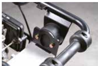
Система подавления ударной нагрузки сокращает передачу вибрации на руки и улучшает удобство оператора
