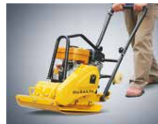
MSR60 с резиновым коврик для уплотнения кирпича и брусчатки в комплекте.
